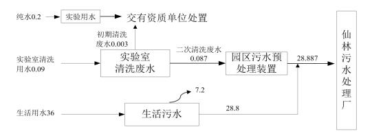
图 2-1 本项目水平衡图 (t/a)
