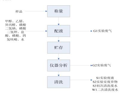
图 2-2 药品检测分析工艺流程图
